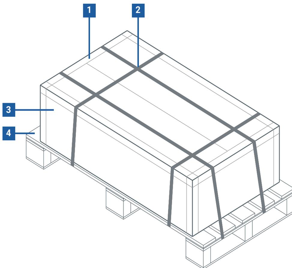
アクセサリを梱包材から取り出し、上部の梱包材を外してシステムが見えるようにします。緩衝材からシステムを慎重に持ち上げ、ESD プラスチック バッグから取り出します。インストールの際は、システムの展開ガイド（箱に入っています）と StrataDOC（下記のリンクからオンライン アクセスできます）の手順を続行します。
